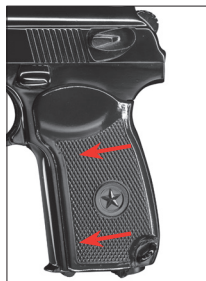
Remplacer la plaquette de crosse.
