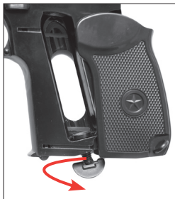
Dévisser à fond la vis de pression de la capsule.
